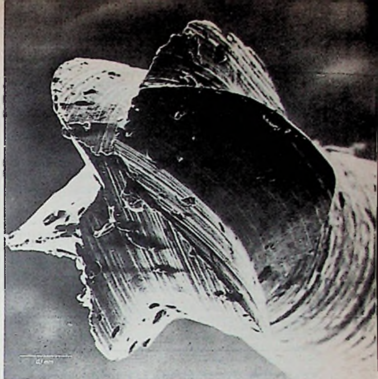
Afb. 4. Een tandartsenboor. Door de enorme dieptescherpte en het „strijklicht” ontstaat een reliëf dat de herkenbaarheid van het object vergroot.
